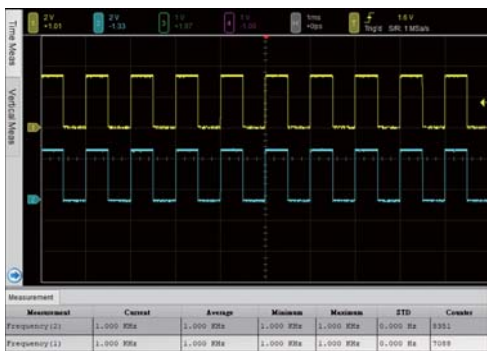
示波器量測 1KHz · 2.5Vpp 的方波
