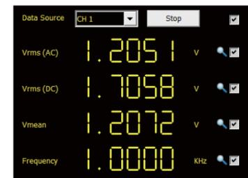
DVM 量測視窗監控 1KHz · 2.5Vpp 的方波
