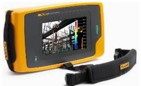
在可見光中準確定位局部放電位置
