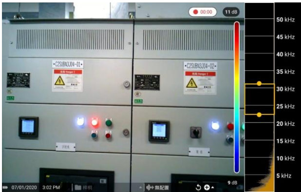
視頻時間起始，1#和2#櫃的散熱板均沒有超聲波能量顯示
