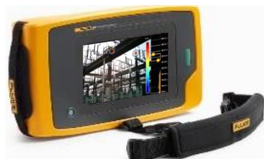
在可見光中準確定位局部放電位置
