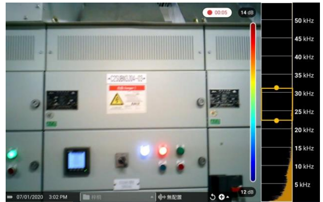
視頻時間5秒，3#櫃的散熱板也沒有超聲波能量顯示
