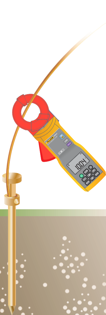
透過 1630-2 設置無輔助極測試法。
