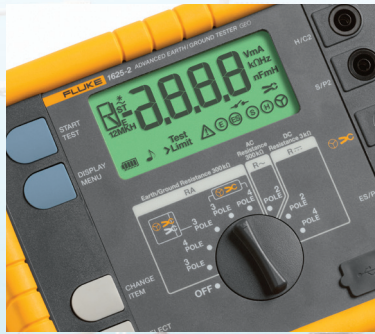
使用 Fluke 1625-2 來判斷接地系統的健全狀況。
