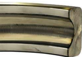
軸承電流造成的軸承套圈凹槽 (感謝 Electro Static Technology 提供圖片)
