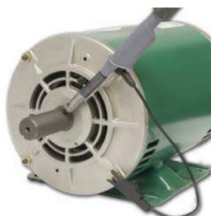
利用 Aegis 軸電壓探頭測量電機軸電壓 (感謝 Electro Static Technology 提供圖片)
