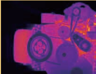
對發動機的散熱系統、排氣系統、傳動系統進行熱分佈檢測，改善設計佈局
