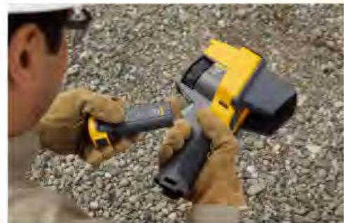
Ti32的現場可置換電池及選配遮罩，不論您在何處工作，都能為您提供最大的使用彈性。
