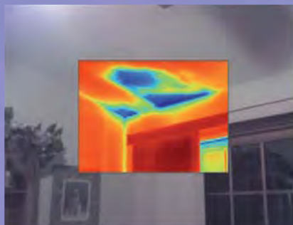
画中画 (PIP) 模式 红外图像“窗口”周围为可见 (光) 图像画框, 可方便地识别故障, 同时又能利用周围环境作为参照物。
