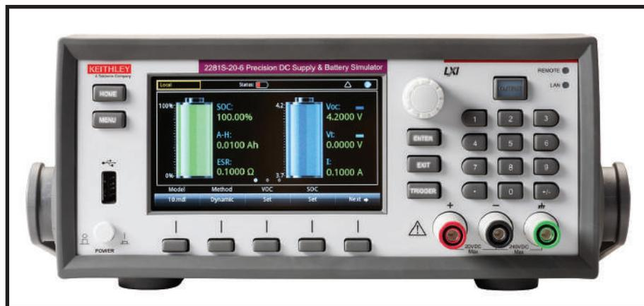
2281S 系列電池模擬器和精密直流電源供應器創新性地整合電池模擬與高精度電源供應器和電池測試的功能；同時也能分析待測裝置的直流消耗、測試電池，並根據電池充電程序產生電池模型，以及根據電池模型模擬電池。2281S-20-6 可以輸出高達 20V 和 6A 的電源，以及輸入高達 1A 的電流。
