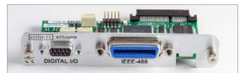
KTTI-GPIB GPIB 介面，附 6 個數位 I/O 連接埠。
