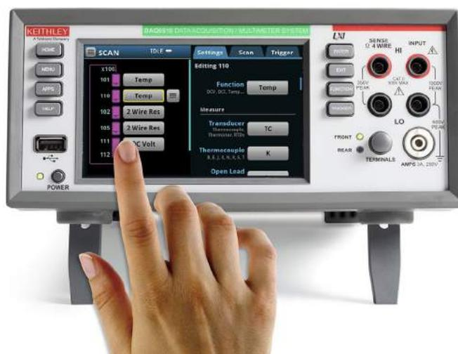
或一組通道。然後，定義量測和掃描之間的時間間隔 (如果需要多次掃描)。這是執行測試所需的最小參數集。另外還有額外的可選參數，可調整量測和切換以滿足特定的應用。系統提供一個可讓您為每個通道建立名稱的選項，輕鬆簡化通道的識別作業。從兩個功能表中執行所有操作，並可在同一個畫面上查看每個通道的配置方式。圖形化的觸控式螢幕顯示器可顯示針對每個通道所設計的通道設定和量測。
