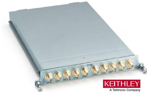
7712 插入式模組提供 50W 雙重 1×4 多工器組合與後面板 SMA 14 個接頭。使用者可級聯多個多工器，以針對大量待測裝置和射頻來源/量測儀器建立可擴展的矩陣和多工器系統。每個多工器列中的一個通道一律閉合至相應的 OUT 接頭。7712 的 3.5 GHz 射頻切換功能非常適合在 2.4 GHz 和較低的工業、科學和醫療 (ISM) 無線電頻段中測試無線模組操作。
