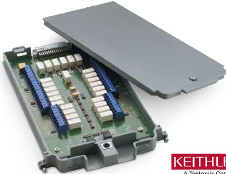
7700 插入式模組提供 20 通道雙極或 10 通道四極多工器切換，可配置為兩個獨立的多工器組。另外還有兩個額外的保護通道可進行電流量測。提供自動CJC，不需要其他配件即可進行熱電偶溫度量測。此外，7700 還包含鎖存機電繼電器，可提供高達 50 MHz 的訊號頻寬。7700 非常適合用於 RTD、熱敏電阻和熱電偶溫度等應用。
