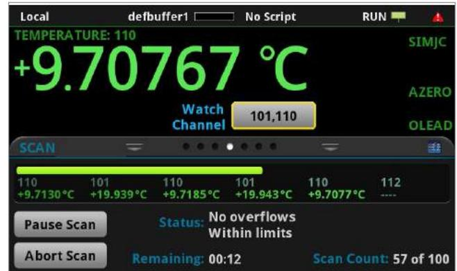
透過 DAQ6510 掃描狀態畫面即可快速又輕鬆地監控測試狀態。
