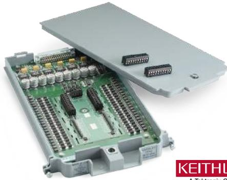
7710 插入式模組提供 20 通道雙極或 10 通道四極繼電器輸入，可配置為兩個獨立的多工器組。繼電器是固態形式，使用壽命超長且僅需少量的維護。固態繼電器的壽命通常比機械繼電器長 100 倍。非常適合長期的資料記錄應用以及要求嚴苛的高速應用。
