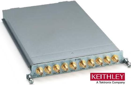
7711 插入式模組提供了一種經濟實惠的寬頻帶訊號路由解決方案，補充了 Integra 系列系統的直流/低頻切換和量測能力。7711 提供雙重 1×4 組態，並可與各種外部交流儀器以介面連結，包括示波器、脈衝產生器和訊號分析工具。每個多工器列中的一個通道一律閉合至相應的 OUT 接頭。所有連接均可從後面板輕鬆存取。
