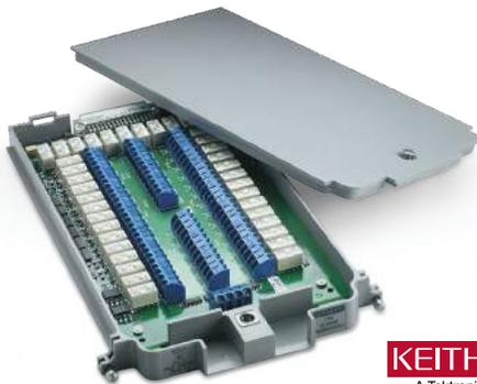
7708 插入式模組提供 40 通道雙極或 20 通道四極多工器切換，可配置為兩個獨立的多工器組。內建的CJC感應器可自動線性化熱電偶，使 7708 成為 RTD、熱敏電阻和熱電偶溫度應用的理想選擇。同時，此模組也非常適合需要多點監測的混合訊號量測應用，如環境壓力篩選。
