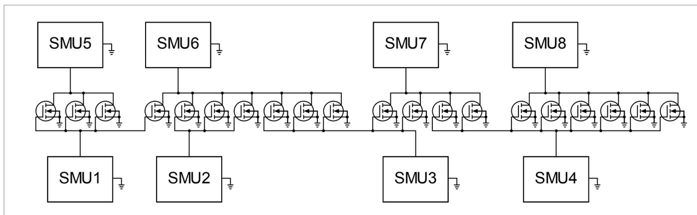
使用 8 個 SMU 對 20 個並列裝置加壓以進行 HCI 和 NBTI 測試的範例。使用單獨的接地設備 (GNDU) 作為共用終端。
