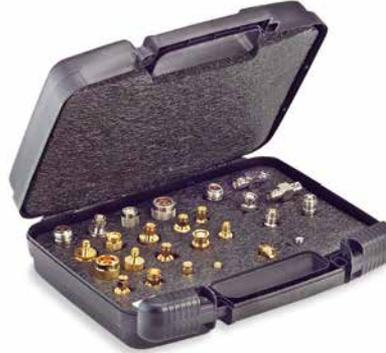
齐全的套件，包括最常用的 50Ω 射频 (RF) 适配器，存放在坚固耐用的手提箱内。支持直接适配，无需中间耦合器。全部零件为精密加工黄铜，非压铸，采用抗变色镀镍层。公头的中心插针触点为镀金黄铜。母头的中心触点为镀金、热处理铍铜。绝缘材料为高密度 PTFE。
