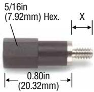
该适配器通过替代端子板上的螺钉提供香蕉插孔连接。利用标准香蕉插头跳线可实现牢固连接, 无需断开端子板的连接。香蕉插头直径为 4.22mm (0.166in)。
