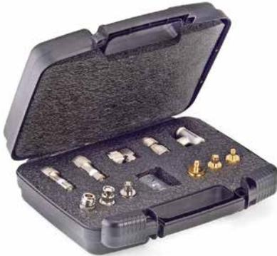
整合套件，包括最常用的 N 型适配器，存放在坚固耐用的手提箱内。支持直接适配，无需中间耦合器。全部零件为精密加工黄铜，非压铸，采用抗变色镀镍层。公头的中心插针触点为镀金黄铜。母头中心触点为镀金、热处理铍铜。绝缘材料为高密度 PTFE。
