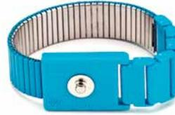
由非过敏性不锈钢制成，每条腕带表面有一层 2mm (0.08in) PVF 薄膜。无需工具可快速、方便地调节，腕带适合绝大多数用户。标准 0.16in (4mm) 子母扣支持连接到电阻卷线。
