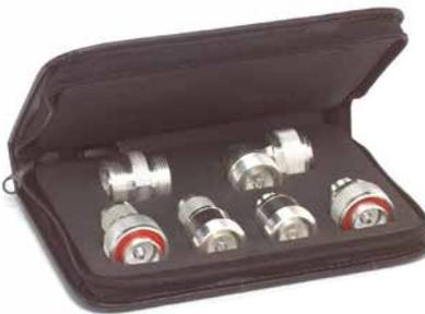
该套件可确保现场维修人员能够将采用 7/16 DIN 连接器的设备连接到采用 N 型连接器的设备。这些连接器互不兼容，但常用于相同类型的电话设备和测试设备。
