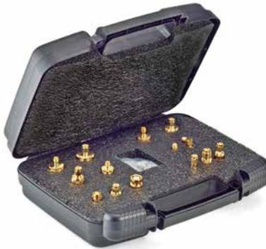
整套套件，包括最常用的 SMA 适配器，存放在坚固耐用的手提箱内。支持直接适配，无需中间耦合器。全部零件为精密加工黄铜，非压铸，采用抗变色镀镍层。公头的中心插针触点为镀金黄铜。母头的中心触点为镀金、热处理铍铜。绝缘材料为高密度 PTFE。
