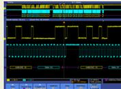
I<sup>2</sup>C 串列匯流排解碼可顯示位址和資料封包內容
