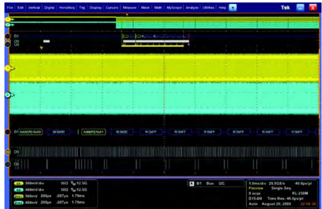
10ms 时长内使用 25GS/s 捕获同步的高速和低速信号
