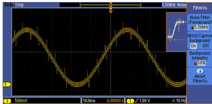
DAC 訊號輸出 – 請注意 FilterVu™ 如何清楚顯示前景軌跡 (黃色) 的 DAC 無雜訊步驟，此種軌跡移除了所有 5.5 kHz 以上的頻率。FilterVu™ 也會在背景軌跡中 (橘色)，擷取和顯示達示波器完整頻寬的高頻突波。
