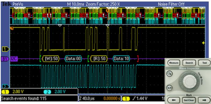
搜尋 – I<sup>2</sup>C 解碼顯示 Wave Inspector 搜尋位址數值 50 的結果，Wave Inspector 控制提供在檢視和瀏覽波形資料時前所未有的效能。
