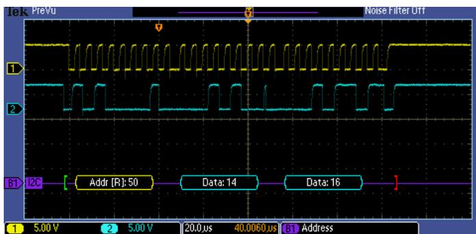
觸發通過 I<sup>2</sup>C 匯流排的特定資料封包。黃色波形表示時脈，藍色波形表示資料。匯流排波形提供解碼封包的內容，包括：Start (起始)、Address (位址)、Read/Write (讀取/寫入)、Data (資料) 及 Stop (停止)。
