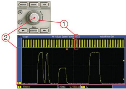
Wave Inspector 控制在檢視、瀏覽及分析波形資料方面，提供了前所未有的效能。旋轉外圈取景控制 (1) 可加速 1 Mpoint 點記錄播放，使您在幾秒內即可從頭到尾瀏覽過記錄。想檢視感興趣的事件或是想看到更多的訊號細節？只需旋轉內圈縮放控制 (2)。
