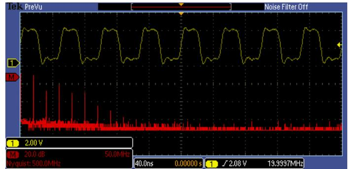
分析 – 脈衝訊號的 FFT 分析。一套全方位的整合分析工具可加速您設計效能的驗證。
