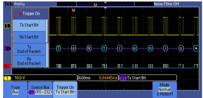
擷取 – 觸發整個 RS-232 匯流排的特定傳輸資料封包。一套完整的觸發器，包括觸發特定串列封包內容，確保您能迅速擷取到感興趣的事件。
