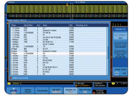
► 封包解碼表可顯示長時間擷取資料中每一個 CAN 封包的解碼識別碼、DLC、資料及 CRC。
