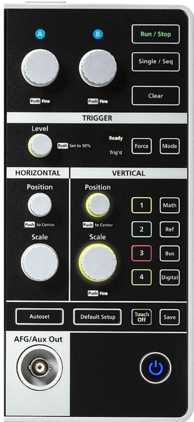
簡化的直覺式前面板，具有不同色彩的 LED
