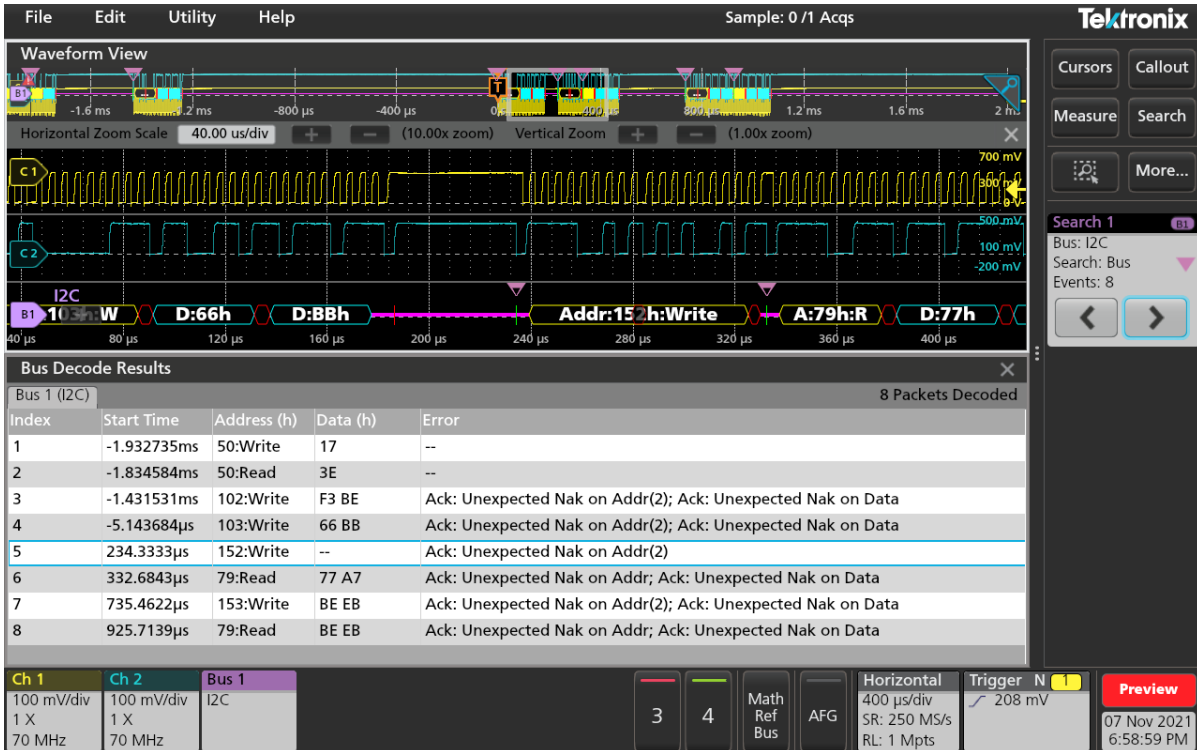
匯流排波形會提供對應時間的解碼封包，而匯流排解碼表則會呈現整個擷取的所有封包，並可使用搜尋加以瀏覽
