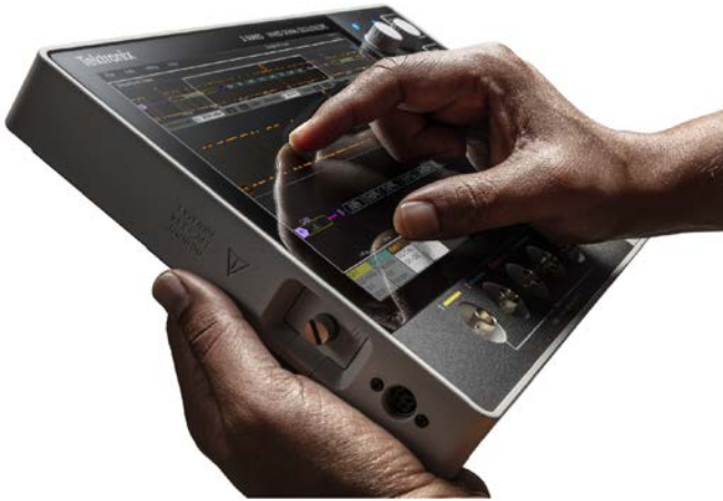
使用電容式觸控顯示器進行互動
