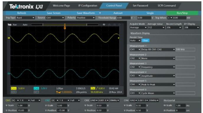
LXI 可控制螢幕和波形顯示啟用遠端控制 (透過乙太網路)
