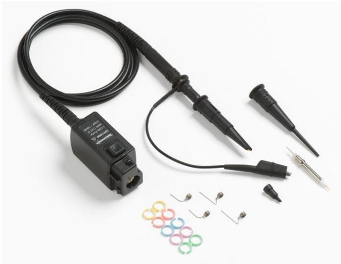
TPP1000、TPP0500B、TPP0502 和 TPP0250 機型為 Tektronix 的高頻寬通用型探棒，能提供同級產品中前所未有的突破性規格。這些探棒專為搭配 Tektronix MDO3000、MDO4000、MSO/DPO5000 和 5 系列 MSO 系列示波器使用所設計，提供高達 1 GHz 的類比頻寬與低於 3.9 pF 的電容性負載。
