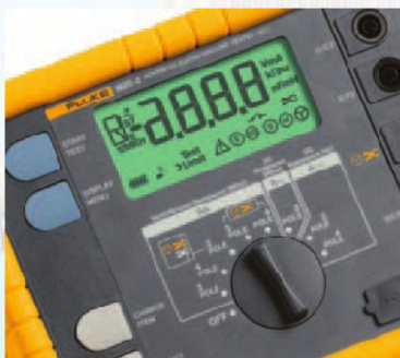
利用 Fluke 1625-2 測定接地系統的狀況。
