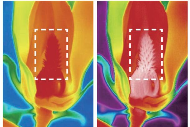
因素二：最小檢測尺寸決定了熱像儀捕捉細小尺寸的能力。尺寸越小，相同面積的檢測目標畫面由更多像素組成，畫面更清晰。
