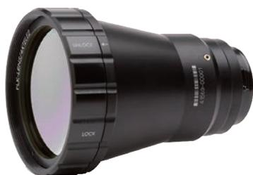
可將遠處的目標放大至 4 倍，在目標上的有效測溫像素提高至標準鏡頭的 16 倍；若無需提高目標清晰度，最遠檢測距離可提升至標準鏡頭的 4 倍。例如：對於 5 公分的輸電線路線夾，標準鏡頭最遠檢測距離為 38 公尺，4X長焦鏡頭的最遠檢測距離可達 153 公尺。
