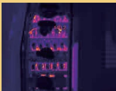
發電機定子老化導致過熱
