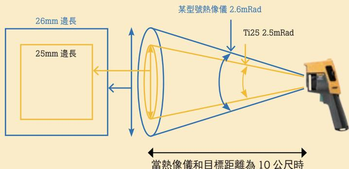
圖示：距離 10 公尺時，每個紅外線像素能檢測到的被測目標的邊長。
