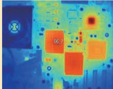
檢測電路板晶片，幫助進行器件篩選
