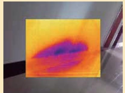
在表面乾燥的情況下可檢測出室內牆壁內部是否滲水
