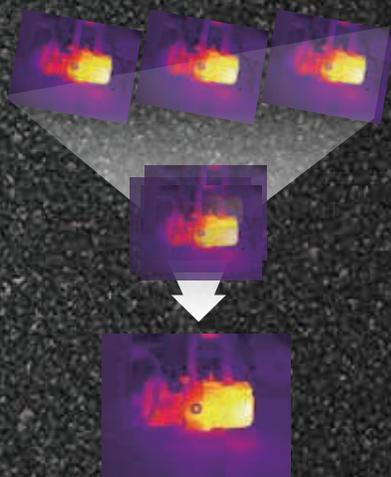
③ **高螢幕更新模式**：可選60Hz/120Hz/240Hz，提高熱像儀的即時捕獲溫度的能力，觀察溫度的快速變化。
