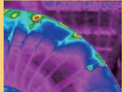
蒸汽管道隔熱損壞
