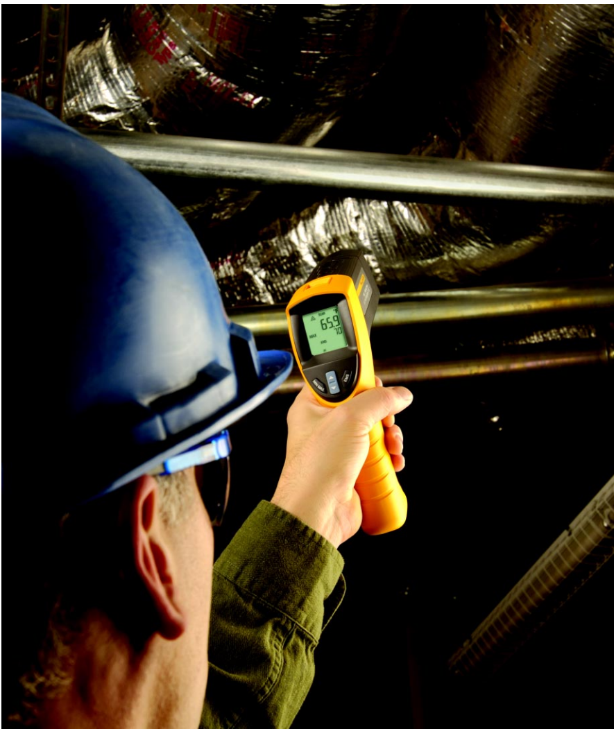
通过这种快速扫描方式可以发现不同部位温度的显著差别，从而发现是否存在保温层泄漏问题。但是，为保证读数准确，必须首先根据保温材料的发射率和反射率调整仪器的发射率。
