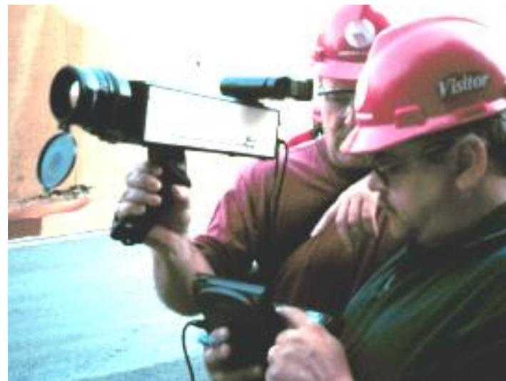
製冷型熱像儀巨大的體積和重量使當時的紅外熱像檢測成為絕對的“體力活”。
