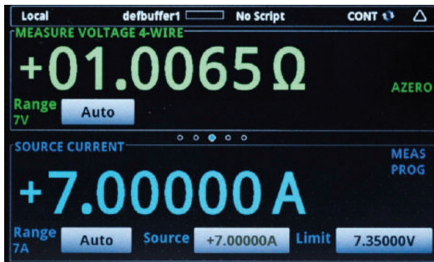
圖 3. 繪圖電源量測設備 (SMU) 可以顯示源電流和 4 線電阻量測，具有高準確度
