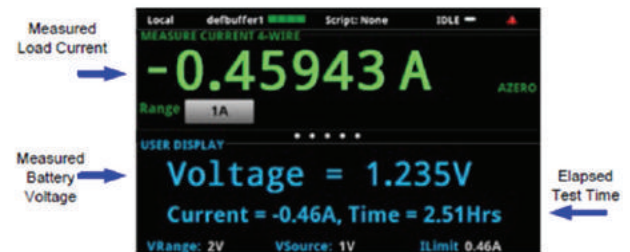
圖 3. 可繪圖電源量測設備 (SMU) 可以顯示負載電流、電池電壓以及充電或放電經過的時間
