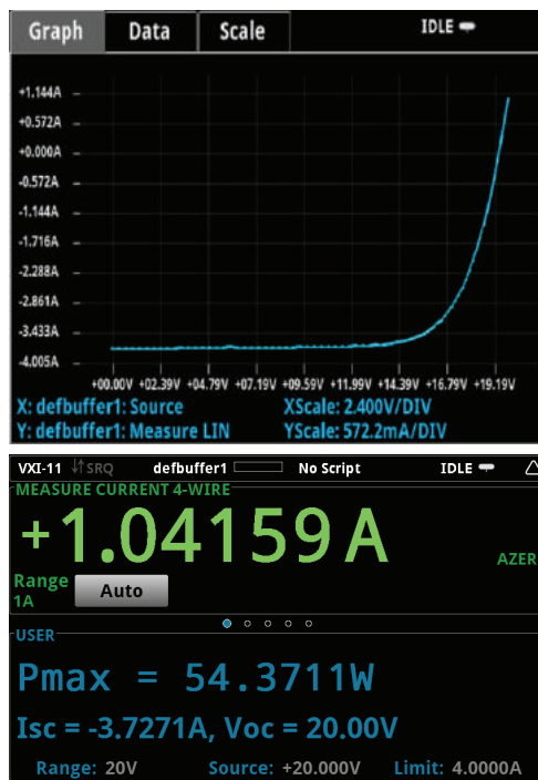
圖 3. 可繪圖的電源量測設備 (SMU) 可以顯示太陽能電池的 I-V 曲線，並顯示最大功率 (Pmax)、短路電流 (Isc) 和開路電壓 (Voc)。
