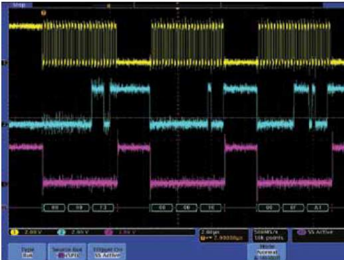
圖 13. 正確的合成器配置訊息。
