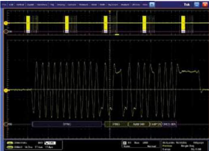
圖 23. 在搭配選項 SR-USB 的 MSO5024 上，以序列觸發功能擷取已解碼的高速 USB 2.0 波形。
