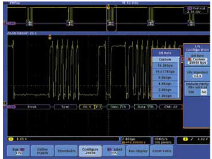
圖 34. LIN 匯流排設定功能表和已解碼訊框。
