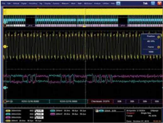
圖 53. MSO70000C 類比通道解碼組合像素流後的顯示畫面，顯示總和檢查錯誤。
