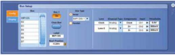
圖 51. MIPI DSI-1 匯流排設定。
