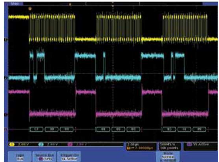
圖 12. 擷取經由 SPI 匯流排的合成器配置訊息。
