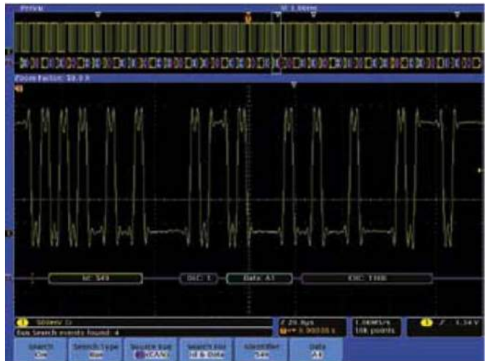
圖 44. 在 CAN 匯流排擷取中搜尋特定的辨識符和資料。
