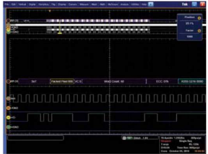
圖 52. MSO70000C 數位通道解碼組合像素流、24 位元 RGB 8-8-8 格式長封包後的顯示畫面。
