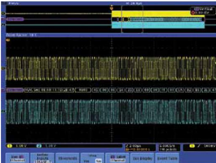
圖 25. 10BASE-T 解碼顯示畫面。
