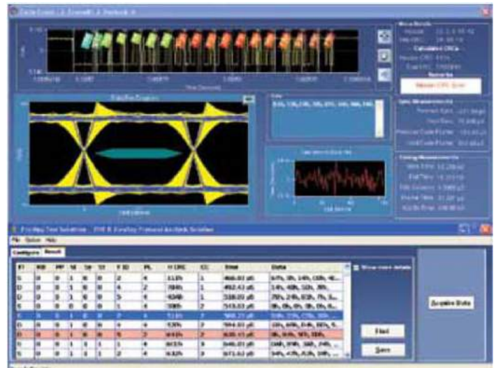
圖 43. FlexRay 訊號的 DPO4AUTOMAX 眼狀圖分析。
