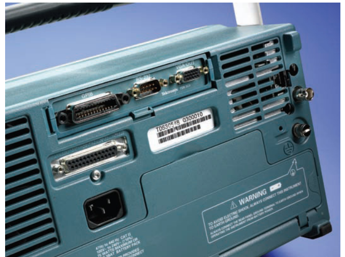
圖 53. 目前的示波器提供了廣泛的一系列通訊介面，如標準配備 Centronics 埠及選配乙太網路/RS-232、GPIB/RS-232 和 VGA/RS-232 模組。其前面板上甚至還有一個 USB 埠（畫面中沒有顯示）。
