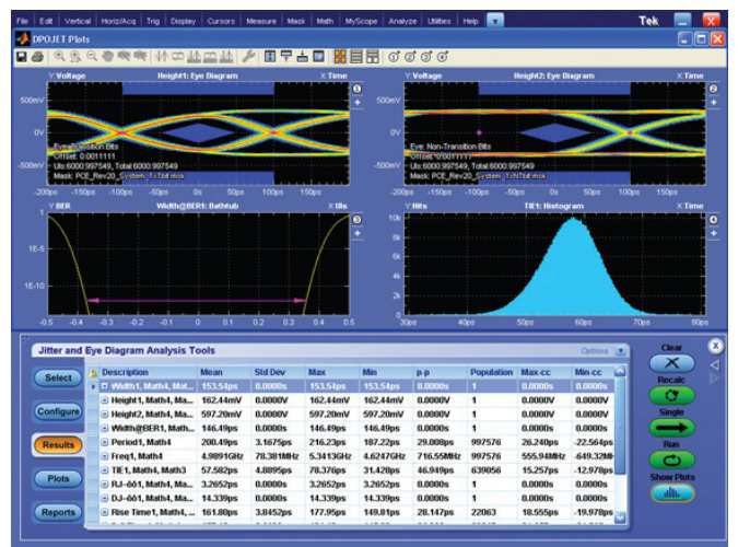
圖 54. 分析套裝軟體是為滿足目前高速數位設計人員的抖動和眼狀圖量測需求專門設計的。
