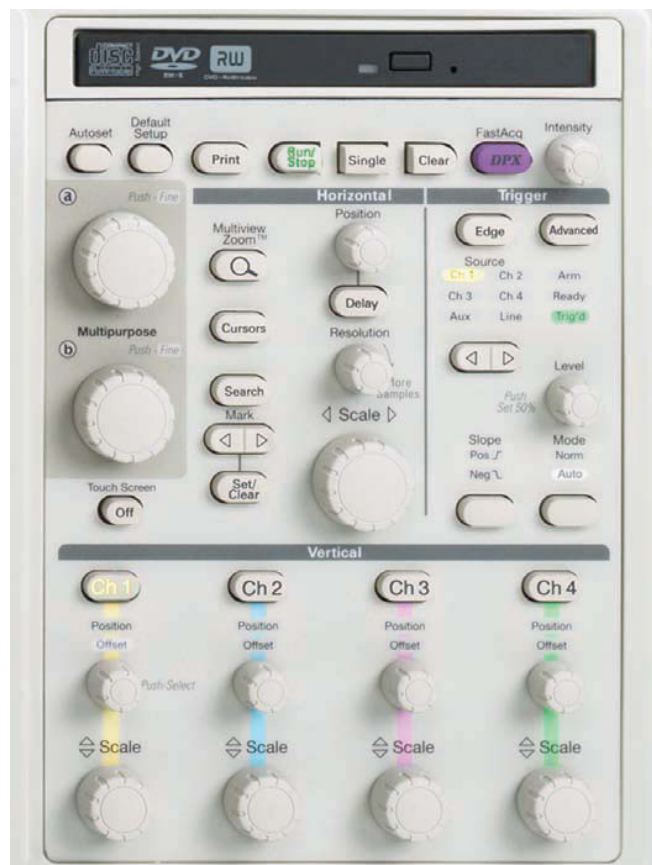
圖 20. 示波器的前面板控制功能區域。
