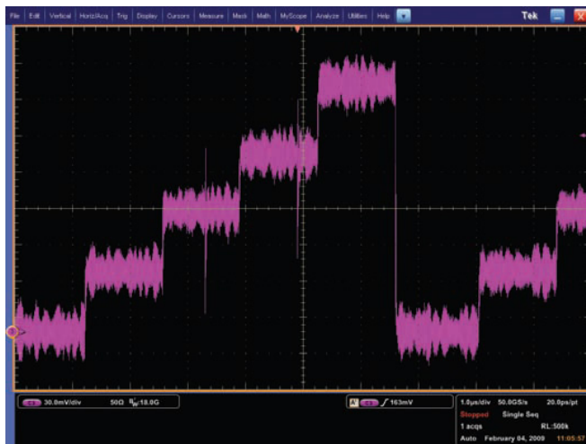
圖 24. 峰值偵測模式使得示波器能夠擷取非常短的暫態異常訊號。
