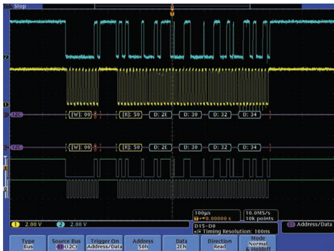
圖 55. 自動觸發、解碼和搜尋串列封包上下文加快了串列匯流排分析速度。
