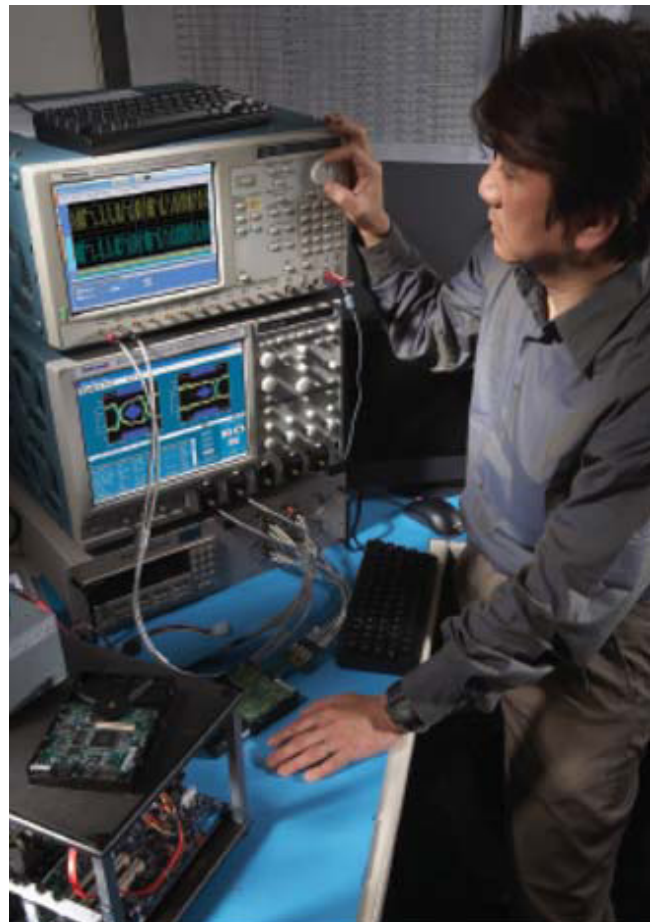
圖22：這些工具包括數位螢光示波器、邏輯分析儀、即時頻譜分析儀、時域反射儀、任意波形產生器和高保真度的探棒系統以及分析軟體。
