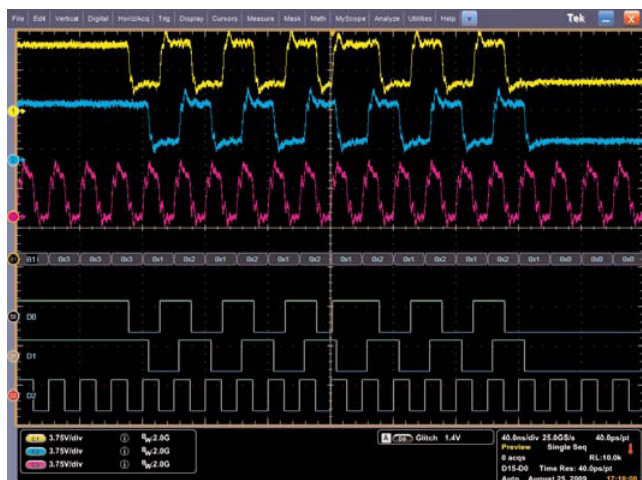
圖 14：利用同一畫面上所顯示的時間相關數位和類比量測值，可快速找出串音錯誤。
