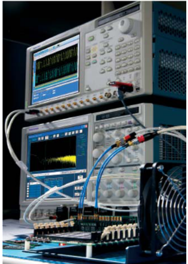
圖21：許多量測系統都是由擷取設備和訊號來源設備組成。
