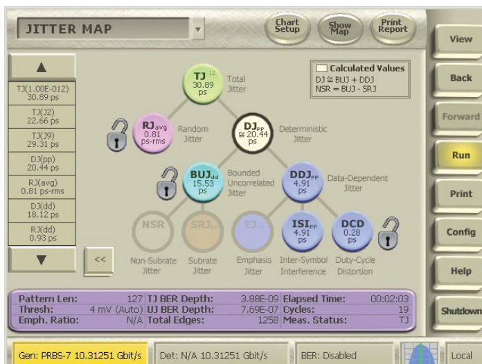
圖 2.4d 水平抖動地圖上的 BERT 和水平抖動值
