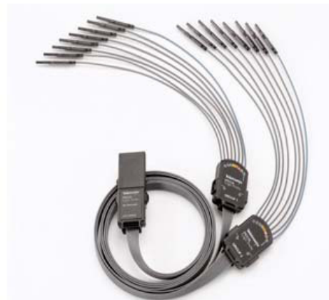
圖2.10. 適用於混合訊號示波器 (MSO) 的邏輯探棒，簡化到您裝置的連接性。
