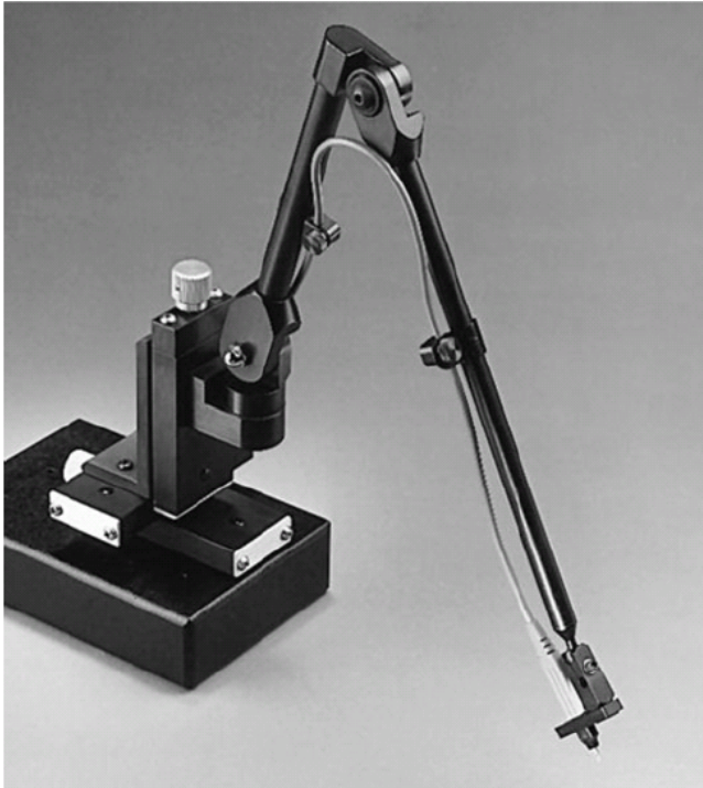
圖2.11. 為探測形狀小的裝置設計的探測站範例，如混合電路和 IC。
