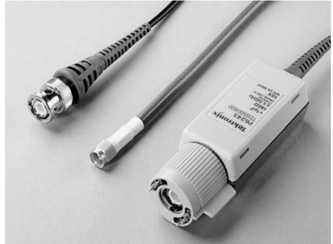
圖2.5. 高電壓探棒提供了 75 MHz 的頻寬，可以量測高達 20 kV 的 DC 電壓及高達 40 kV 的脈衝。
