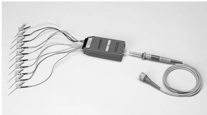
圖2.9. 字識別器探棒。這些探棒允許使用示波器在特定邏輯條件下分析特定資料波形。
