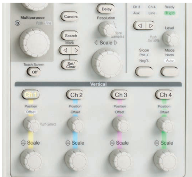
圖 60. 傳統的模擬式旋鈕控制著位置、刻度、亮度等等，完全滿足您的預期。
