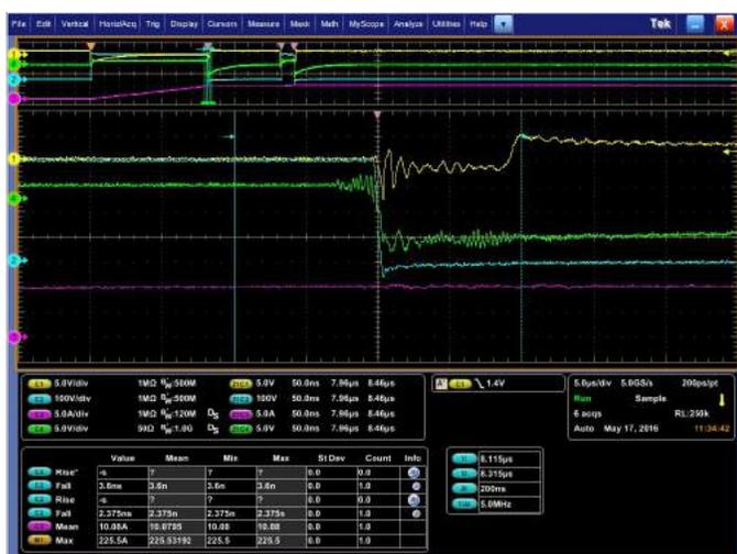
使用 IsoVu 探棒可以精確地擷取高端柵極電壓波形，以評估和最佳化切換效能和可靠性，而不會降低  $dV/dt$ 。
