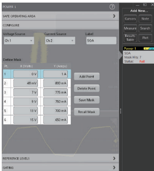
圖 7. SOA 遮罩編輯器視窗。遮罩可由取自切換裝置資料表的一組 (電壓、電流) 座標定義，或可由使用者自行定義。
