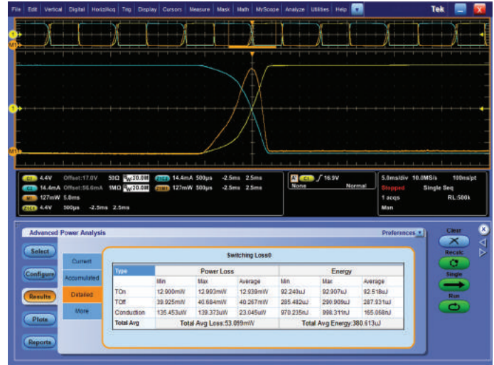
圖 17. 使用 DPOWPR 的切換損耗自動量測。
